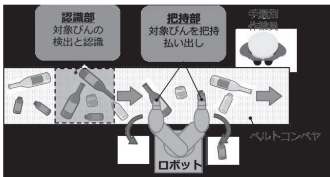
図7 ロボットによる選別システムの例
